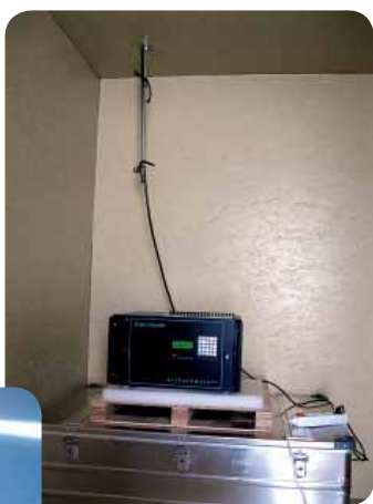
Figure 1.5 : A gauche, l'héliophotomètre CIMEL qui mesure l'extinction totale du rayonnement solaire en présence de particules d'aérosol et à droite, l'éthalomètre qui mesure l'absorption du rayonnement solaire en présence de particules d'aérosol ainsi que la concentration en particules de noir de carbone.
