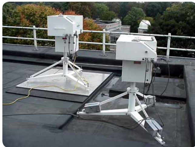
Figure 4.3 : Les instruments Brewer 016 et 178 sur le toit de l'IRM observent l'épaisseur de la couche d'ozone et l'intensité du rayonnement UV.
