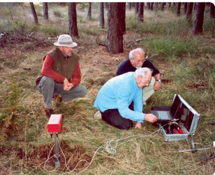
Figure 2.11 : Mesure de la susceptibilité magnétique en fonction de la profondeur (de 0 à 50 cm) dans un sol forestier près de Balen (Prov. Anvers). Le capteur SM-400 (avant plan gauche) mesure la susceptibilité magnétique avec grande résolution spatiale et précision (sensibilité 10 -5 SI) et détecte les zones dans laquelle la pollution anthropogénique s'accumule.
